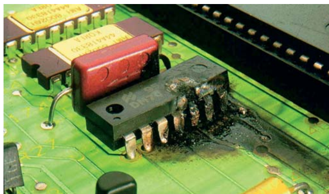
因电涌而受损的电子部件
